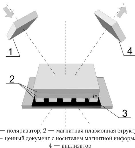
1 — поляризатор, 2 — магнитная плазмонная структура, 3 — ценный документ с носителем магнитной информации, 4 — анализатор
