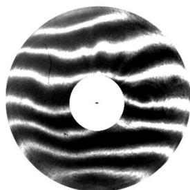
Рис. 10. Интерферограмма, характеризующая качество сформированного пучка лучей
